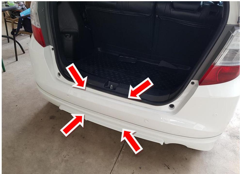
6. 車號 APN-5222 後尾板中央、備胎室後緣 據壓凹陷痕跡。
